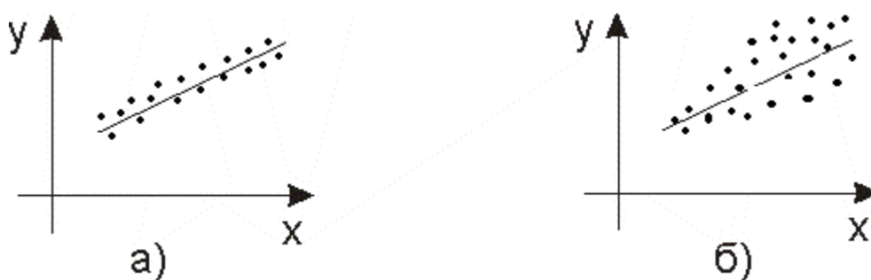
Рис. 2.4.1 Сравнение однородной дисперсии (а) с невыполнением однородности (б) в виде роста дисперсии (гетероскедастичность)
